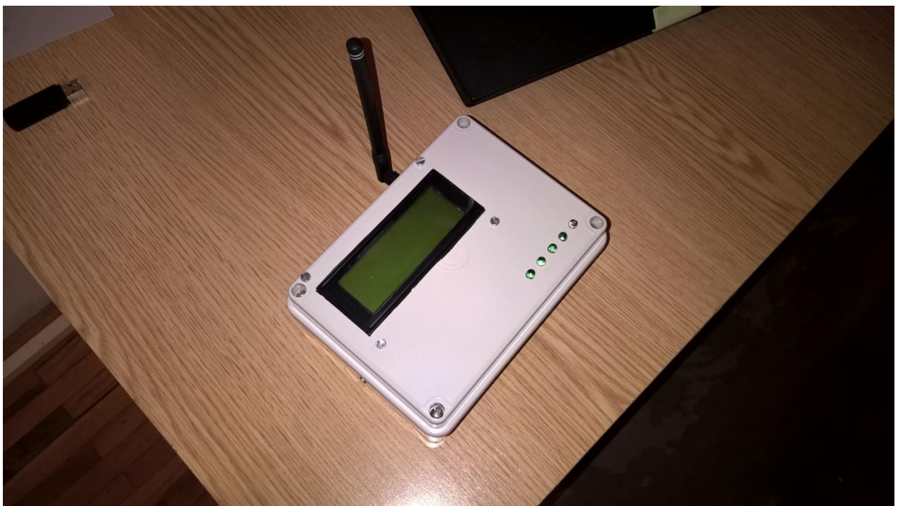
Слика 3. LoRA Tx Мерна станица у варијанти 2
